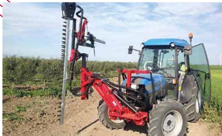
Чеканочная машина П-образного типа для виноградников и живых изгородей. Предназначена для контроля роста вегетации в целом ряду, сформированном на склонах или холмах. Обеспечивает высокую скорость работы, чистый срез, низкие эксплуатационные расходы и отличный обзор из кабины.
