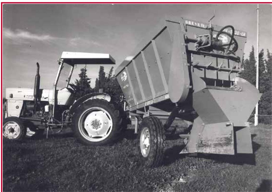
Разбрасыватели твердых органических удобрений (навоз) по поверхности 8, 10 и 13 м<sup>3</sup>. Оснащены внешней приводной цепью, которая не контактирует с удобрением. Машина может достигать ширины работ до 15 м.
