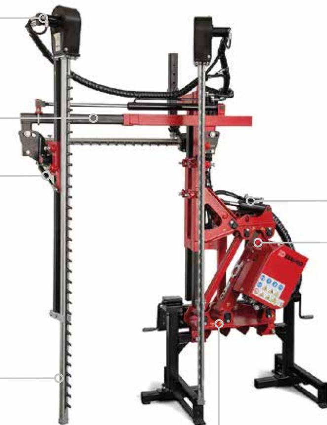
Одновременный наклон вертикальных и горизонтальных режущих стоек
