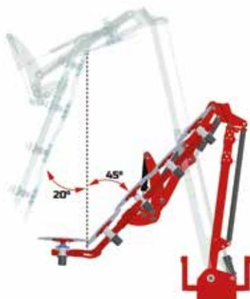
Цилиндр наклона модуля для V-образной обрезки и для обрезки нижней части деревьев
